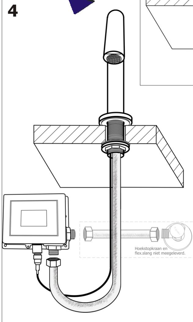
Una vez activada la corriente el aparato entra en una fase de autopruueba después. La zona de detección óptima es configurada automáticamente en esta fase. Procure que no haya objetos extraños frente al sensor ya que podrían afectar la distancia de detección. Pueden pasar unos 30 segundos antes de que se alcance la configuración óptima.
